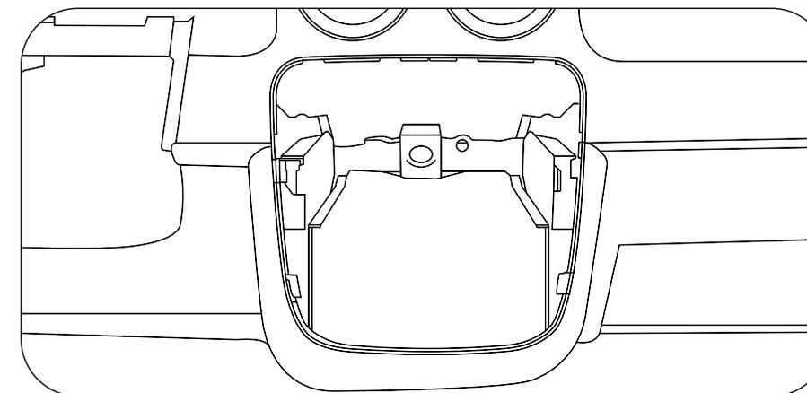
**V** Agora, encaixe a multimídia na moldura. Em seguida, fixe os botões de controle de ar na parte traseira da moldura. Por fim, faça as conexões da multimídia e dos botões dos acessórios do veículo. Agora encaixe a moldura no painel e ela está pronta para uso.
