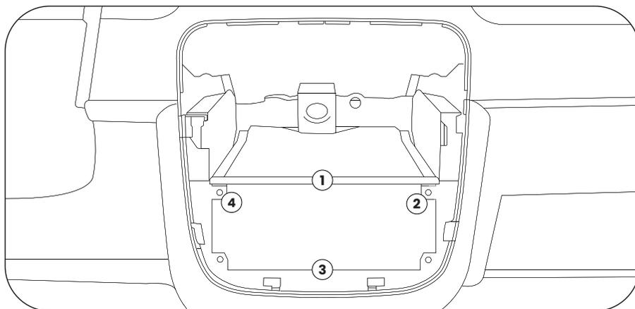
**II** Utilizando uma ferramenta adequada, corte no local indicado e remova a peça de plástico número 1, liberando o espaço acima do controle de ar.
